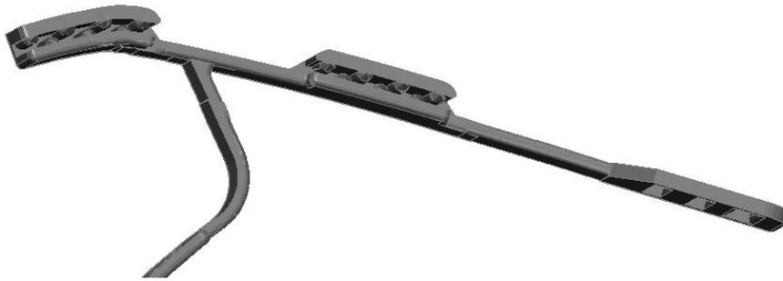
Figure A.6 - Exemple de dispositif de maintien de la visière grâce aux pinces enfichables intégrées
